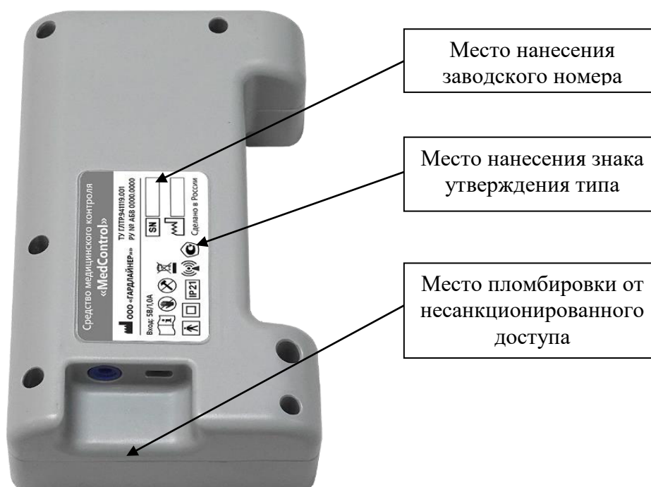
Рисунок 2 – Общий вид средства медицинского контроля MedControl с указанием места нанесения заводского номера и знака утверждения типа
